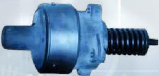
Предназначен для регулирования давления в котле цистерн, перевозящих бензин, нефть, мазут, керосин, дизельное топливо.
