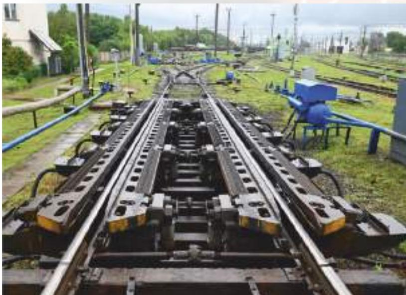
Замедлители исполнения ЗВУ-07 и ЗВУ-15 предназначены для установки на радиусных участках сортировочных горок и на парковых тормозных позициях. Усилие нажатия тормозных шин по оси приводных секций при давлении воздуха в пневмосистеме  $0,65\text{ МПа}$  -  $(125\pm 10)\text{ кН}$ . Максимально допустимая скорость входа вагонного отцепа на заторможенный замедлитель -  $8,5\text{ м/с}$ . Время срабатывания замедлителя не более  $0,7\text{ с}$ .
