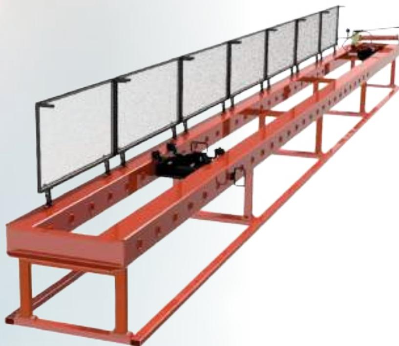
Мы производим надёжные стенды для испытания стропов, предназначенные для проверки прочности и соответствия грузоподъёмных приспособлений установленным стандартам.
