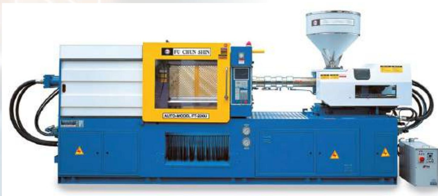
Наше предприятие располагает современным оборудованием — термопласт-автоматами с объёмом впрыска до 1800 см<sup>3</sup>, что позволяет изготавливать широкий спектр изделий из литьевых пластмасс.
