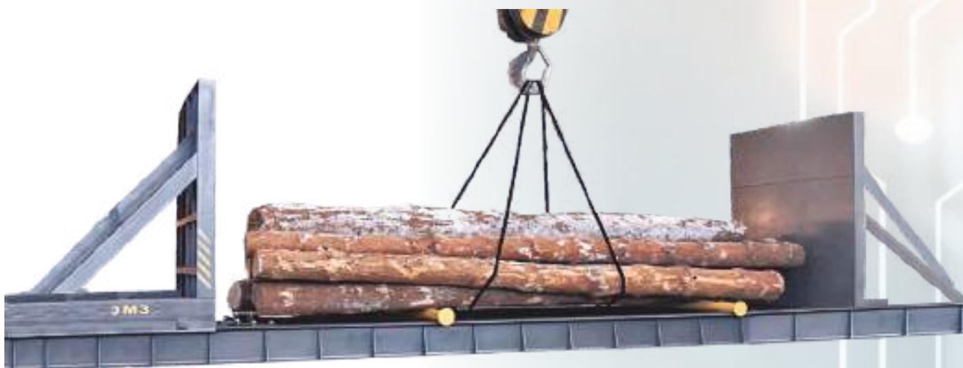
Торцеватель предназначен для выравнивания в одну плоскость торцов бревен или пиломатериалов в пакете перед погрузкой в железнодорожный или автомобильный транспорт.
