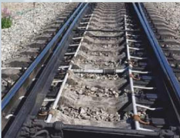
Арматура пневматической очистки стрелок предназначена для пневмоочистки (пневмообдувки) стрелок от снега струями сжатого воздуха зоны прилегания острия к рамным рельсам на стрелочных переводах.
